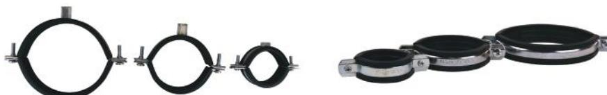
بسته های روکشدار تک پیچ و دو پیچ از بسته های پر مصرف در سیستم تاسیسات ساختمانی می باشند که برای ثابت نگه داشتن لوله های مختلف آبرسانی، پوش فیت، فن کویل و فاضلاب مورد استفاده قرار می گیرند. این نوع بست از دو بخش آهنی تشکیل شده که به وسیله یک یا دو پیچ به یکدیگر متصل گردیده و یک لایه روکش لاستیکی از جنس EPDM و NBR بر روی بخش آهنی قرار می گیرد.
