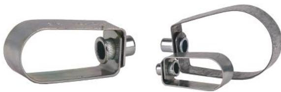
بست گلابی (اسپرینکلر) در سیستم اطفا حریق جزو متدائل ترین بست جهت مهار لوله های آتش نشانی می باشد. این نوع بست از فولاد استاندارد در ضخامت های مختلف در سایزهای ۱/۲ اینچ تا ۸ اینچ تولید شده که دارای مهره پرچ M12 تا M8 می باشد.
